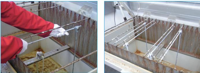
連接夾具人工老化測試潮濕的硫化物氣體試驗
