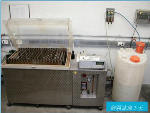
連接夾具人工老化測試 EN 50164-1
