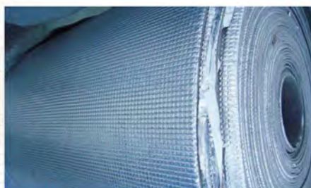
鍍鋁泡棉 XPE 隔熱保溫材料
