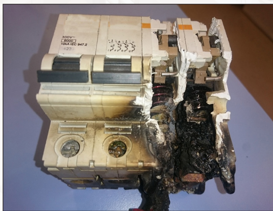
圖 3 塑殼斷路器內部爆炸
