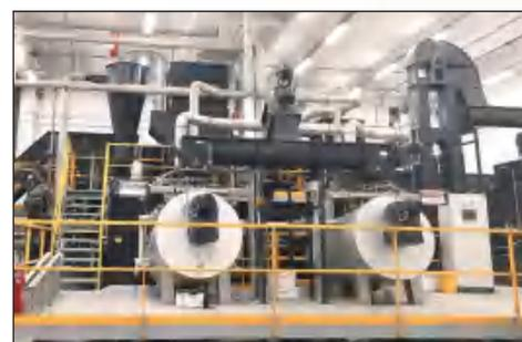
圖 3 進行脫氣作用的蒸汽鍋爐
