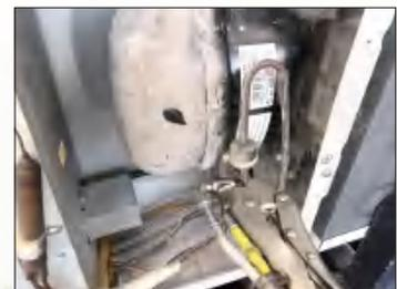
圖 1 用於夾緊雪櫃或冷氣機的冷凝器盤管的抽吸鉗
