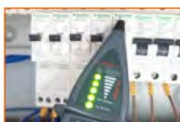
尋找與發射器所連接的 MCB / RCB / RCBO / Fuse
