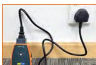
將發射器正確連接到電路 (需帶電) 即可使用接收器開始尋找所屬線路
